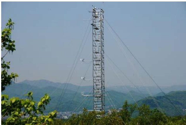
タワーを用いた二酸化炭素 (CO 2 ) 吸収量測定の様子。森林の樹冠より数m～十数m 上で測定した様々な観測データからCO 2 吸収量を求めます。(森林総合研究所 平成24 年版 研究成果選集より)
